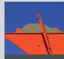
Figura 2. Nell'operazione di sollevamento, il maniglione si alza e il cuneo va ad impegnarsi nella nicchia, la benna a questo punto si alza.
