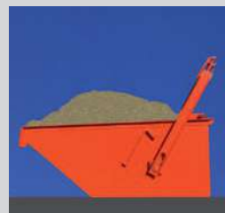
Figura 1. Il manovratore porta il gancio in avanti, il maniglione ruota fino a che il cuneo si trova in posizione di contatto con il lembo dell'elemento di bloccaggio.
