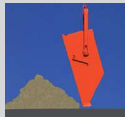
Figura 7. Una volta sollevata, la benna è in posizione verticale e il cucchiaio è completamente vuoto.
