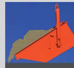
Figura 6. A questo punto il manovratore solleva la benna che comincia ruotando a scaricare il contenuto.
