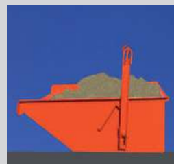
Figura 5. Il manovratore sposta il gancio indietro, il maniglione ruota sganciando il cuneo.
