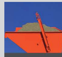
Figura 4. Il manovratore lascia abbassare il maniglione.
