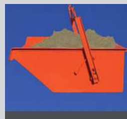
Figura 3. Per poter attuare lo scarico della benna il manovratore la porta in posizione, la appoggia sul piano.
